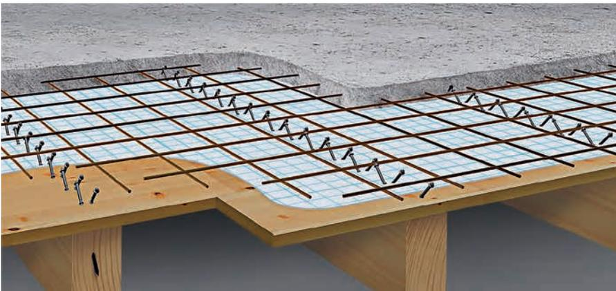
Schematischer Aufbau: Holzbalkendecke, Folie, Schubverbinder, Bewehrung, Betonschicht.
