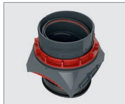
Der Anschluss ist so konstruiert, dass sich der Dichtkragen beim Anziehen des Bauteils mit dem Gewinderadschlüssel stufenlos an die Wandung und den Innendurchmesser des Hauptrohres anpasst.
