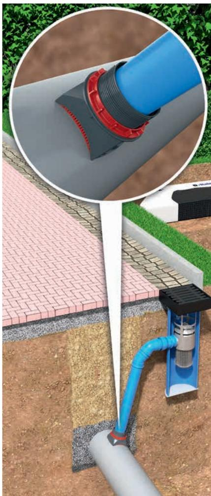
Eine Federblende und ein Distanzring sorgen außen am Rohr für einen formschlüssigen Sitz an der Bohrlaubungskante.
